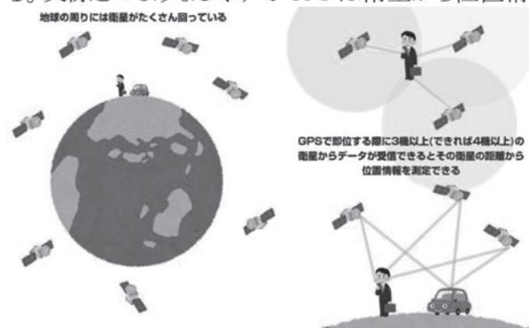
GPS のしくみは簡単に説明すると、上記図のように、地球上にたくさん回っている GPS で利用できる衛星からの電波を利用して、その衛星からの距離をもとに自分自身の位置情報を取得することができるしくみである。
