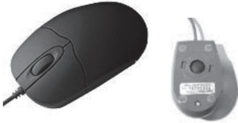
このボールを動かすことで、位置情報を入力してくれる役割をしており、マウスポインタが、動かす方向へ移動してくる。マウスの左クリックと右クリックを押す丁度真ん中に、「ホイール」がある。
