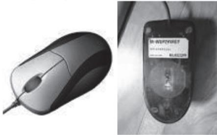
この光が、マウスポインタの位置情報の入力をボールの代わりに光がするようになった。光を反射させることで、位置情報を入力される。
