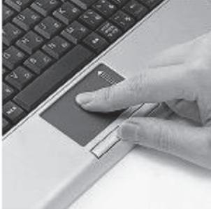
指でなぞることで、位置情報を入力が入力されて、マウスポインタを移動させることができる。指でなぞれる操作面の左側のボタンを押すと、左クリックの役割があり、右ボタンを押すところを押すと、右クリックの役割がある。
