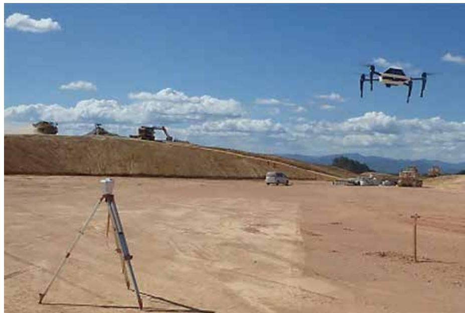
・使用しているドローンは、機体重量は約3kg、飛行時間約17分、通信距離約2km、飛行方法は自動である。
