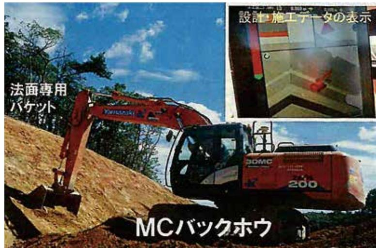
・現場では、GNSS等の位置計測装置を用いたMCブルドーザやMCバックホウを導入している。
