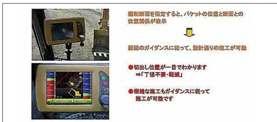
・掘削断面を指定すると、バケットの位置と断面との位置関係が表示される。→画面のガイダンスに従って設計通りの施工が可能。
