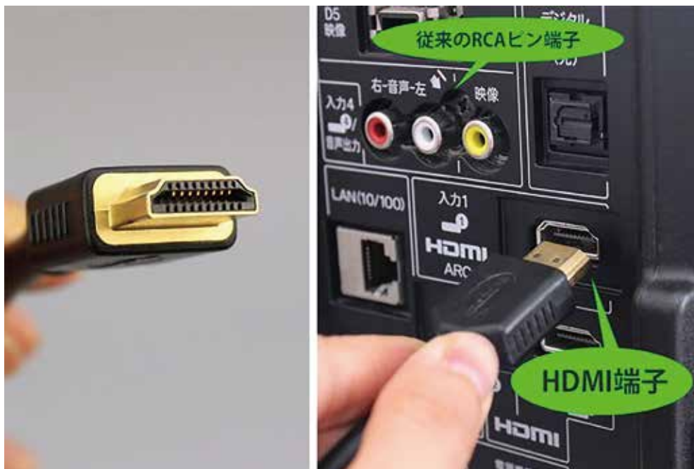
図1.14 HDMI 端子の構造
