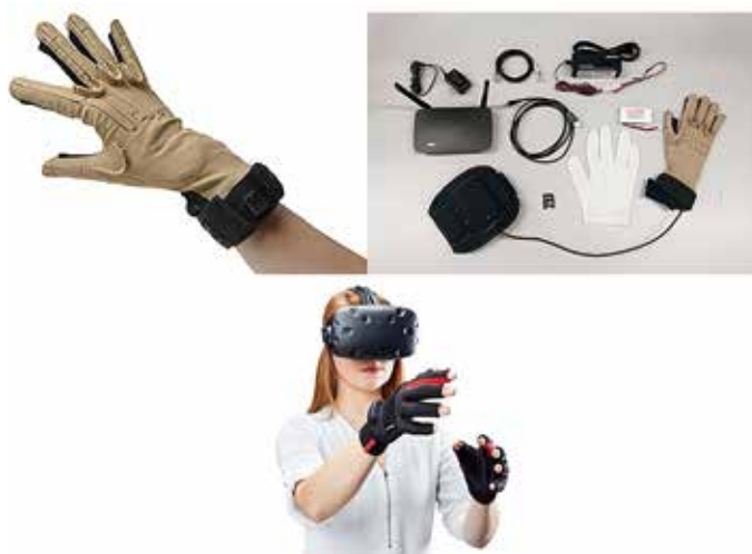
図2.4 データグローブの外観 (出典: https://www.tegakari.net/2017/08/manus_vr/ http://www.nihonbinary.co.jp/Products/VR/PositionTracking/CyberGlove.html )
