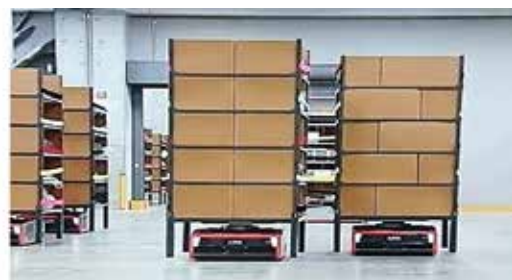
図2.9 物流ロボットによる荷物のピッキング
