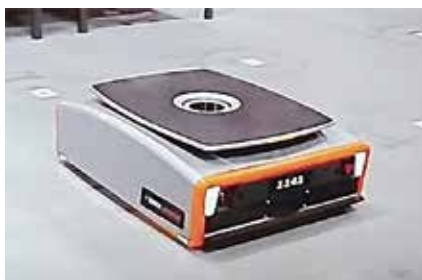
図2.9 物流ロボットによる荷物のピッキング
