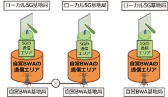
図1.35 4Gのインフラをベースとしたローカル5Gシステムの構築 (出典:総務省総合通信基盤局「第5世代移動通信システム(5G)の今と将来展望」 http://www.soumu.go.jp/main_content/000633132.pdf )
