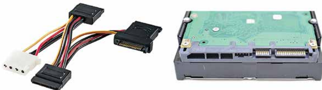
図1.17 SATAケーブルとコネクタの形状 (出典: https://paso-parts.com/upload/save_image/12121105_50c7e66690128.jpg )
