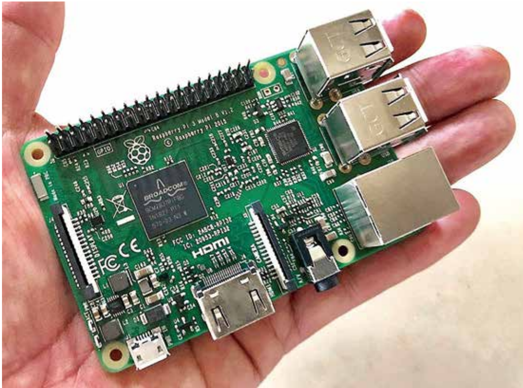
図1.28 GPIOを搭載した小型コンピュータ(ラズベリーパイ) (出典: https://time-space.kddi.com/ict-keywords/20190718/2699 )
