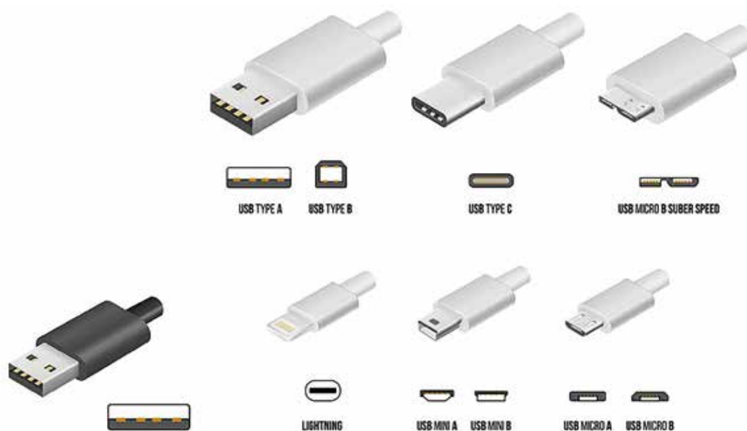
図1.12 USB端子の構造と種類
